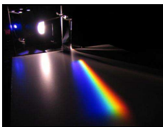
Figura 11 — Decomposição da luz branca através de um prisma.
